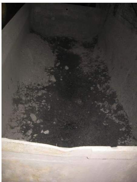
Рисунок 1. – Наслідки адгезії гірничої маси при експлуатації транспортних засобів періодичної дії
