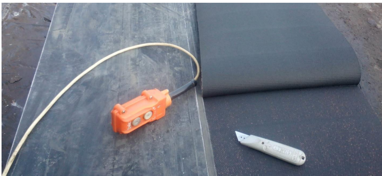
Рисунок - 3. Процесс отслаивания расчетного количества тканевых прокладок из цельного каркаса резинотканевой конвейерной ленты
