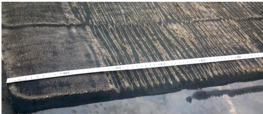
Рисунок 1 – Спиливание гофрообразований шлифовальной машинкой для соединения концов лент способом холодной вулканизации
